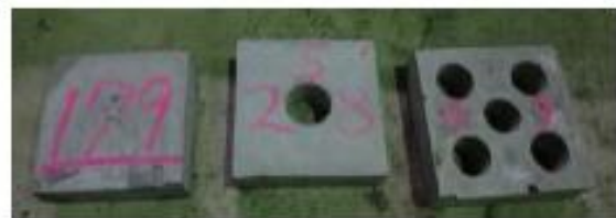
図-2 被覆ブロック模型詳細図 (開口率0% (左), 8% (中央), 24% (右))
