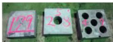
図-2 被覆ブロック模型詳細図 (開口率0% (左)、8% (中央)、24% (右))
