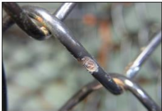
写真－1 塩水噴霧試験状況
