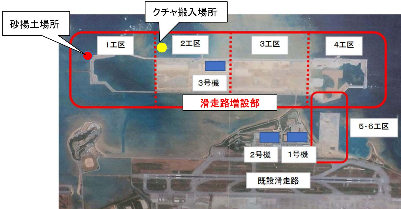
滑走路増設部は、既設滑走路に隣接している。回転式破碎混合機は、既設滑走路側に2基、増設予定地には1基を配置（最大3基稼働）。
