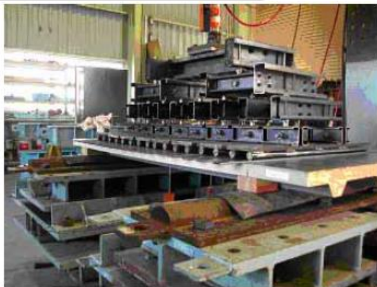
写真-2 チタンパネルの曲げ試験状況
