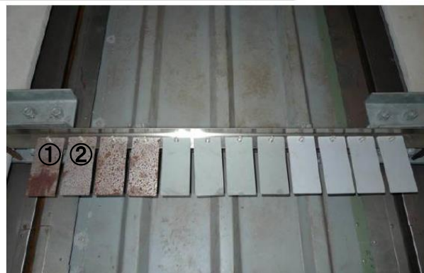
回収前の暴露試験材(左 4 枚:裸鋼、中央 4 枚:ジンク材、右 4 枚:エポキシ材)
