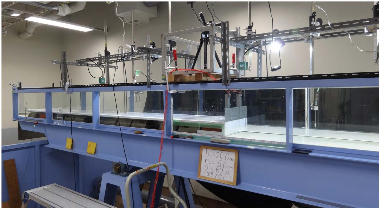
開水路（長さ12m×幅0.4m×深さ0.4m、水平床）
