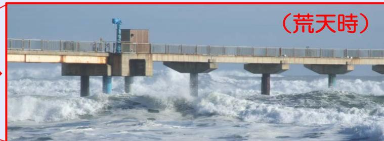
暴露試験材①：鋼管杭フランジレスタイプ（FRPカバー）
