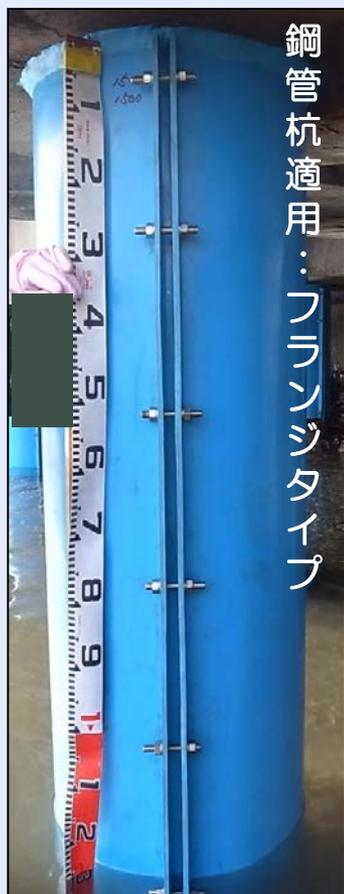
鋼管杭適用：フランジタイプ
