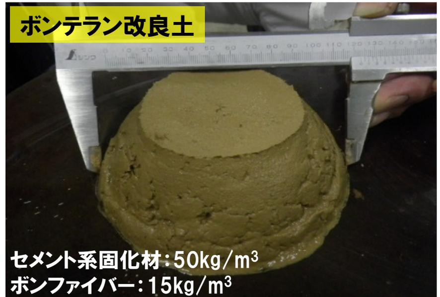
セメント系固化材:  $50\text{kg}/\text{m}^3$
