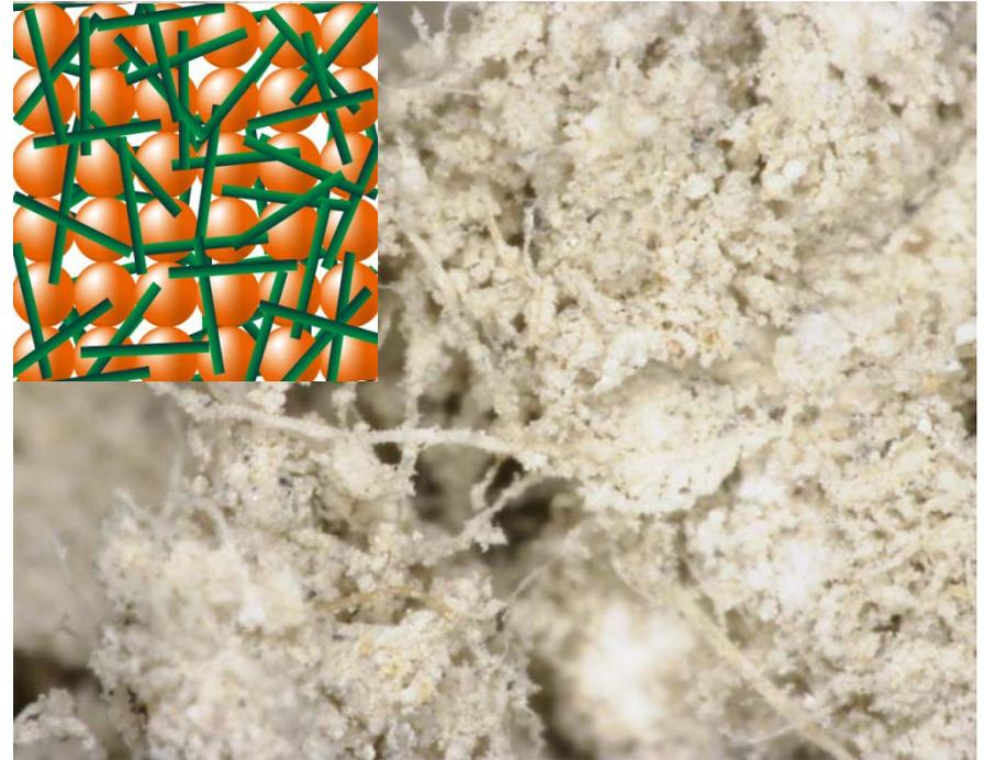
土粒子と土粒子に繊維が絡み合い固化材により繋がっている
