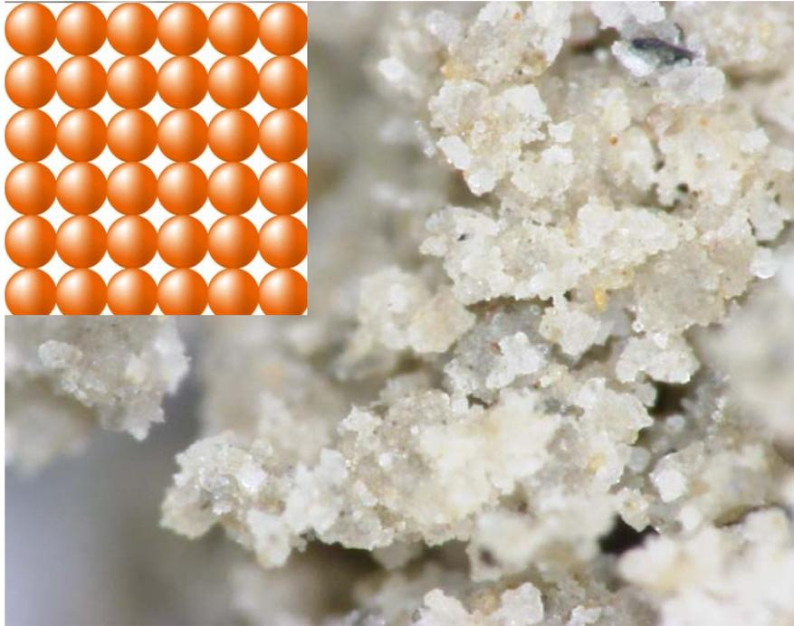
土粒子と土粒子が固化材の結晶により繋がっている
