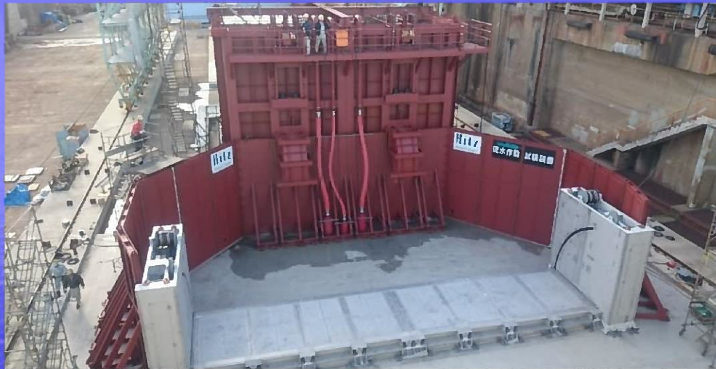
neo RiSe 製品サイズ: 純径間15m × 高3m
