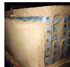
実物大模型による多条埋設管埋戻し施工
