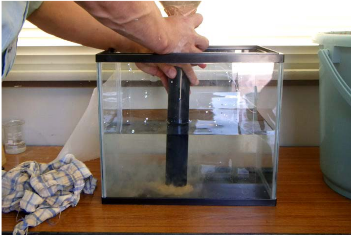
水中打設の様子
