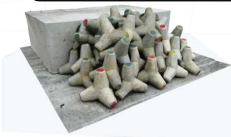
●消波工の点群データ (模型検討)
