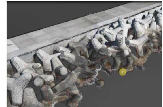
ドローンを用いた測量・解析による 消波工の沈下状況の把握
