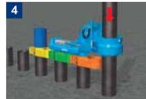
次の杭を建込み、圧入開始
