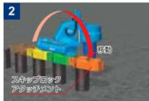
スキップロックアタッチメントを吊移動しセット
