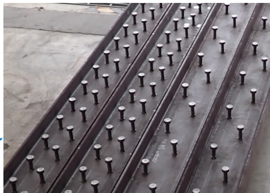
スタッドを溶接したI形鋼材
