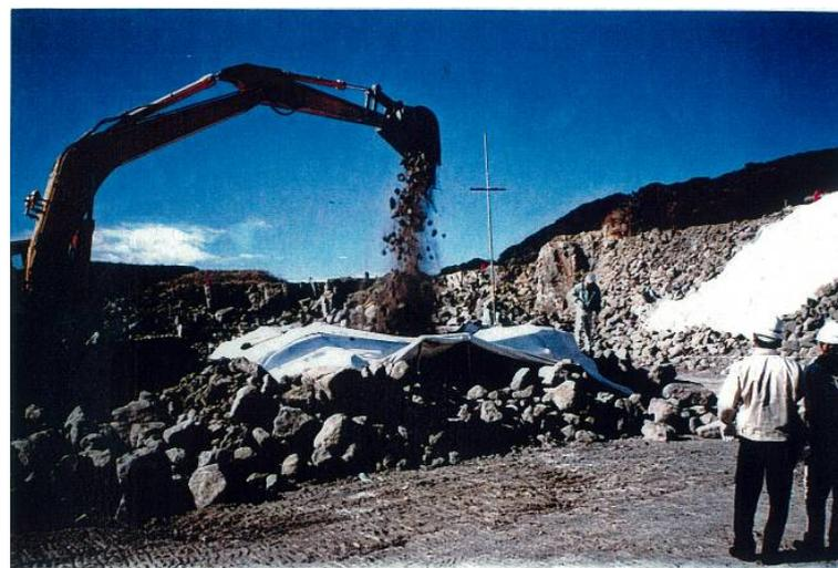
◆ ±70cm(深さ140cm)の不陸を再現し、土砂を投入した実験
