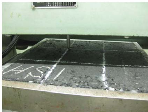
写真-1 静荷重載荷試験状況
